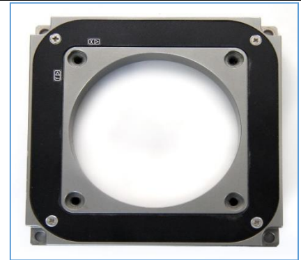
这是 EnvisionTEC 增强分辨率模块的照片，向 X 轴和 Y 轴移动半个像素，稍稍移动 DLP 机器第二次照射位置，减少精细 3D 边缘柔化技术形成的阶梯形状。投影仪光线从模块中央发出。
