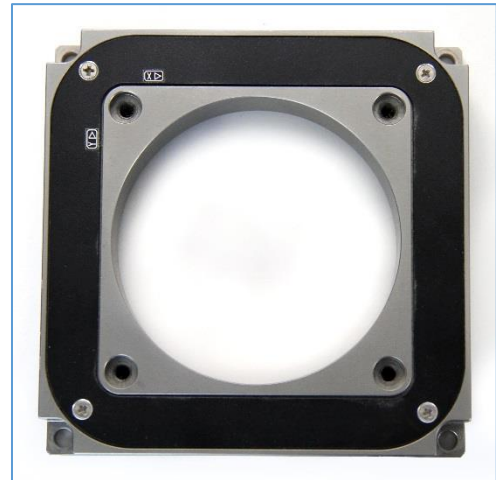
Diese ist die Fotografie des EnvisionTEC Enhanced Resolution Moduls, das ein halbes Pixel auf X und Y verschiebt, damit die zweite Belichtung im DLP-Drucker sich leicht verschiebt und die Abstufung mittels einer hochentwickelten Kantenglättungstechnik reduziert. Der Projektor strahlt durch das Zentrum des Moduls.
